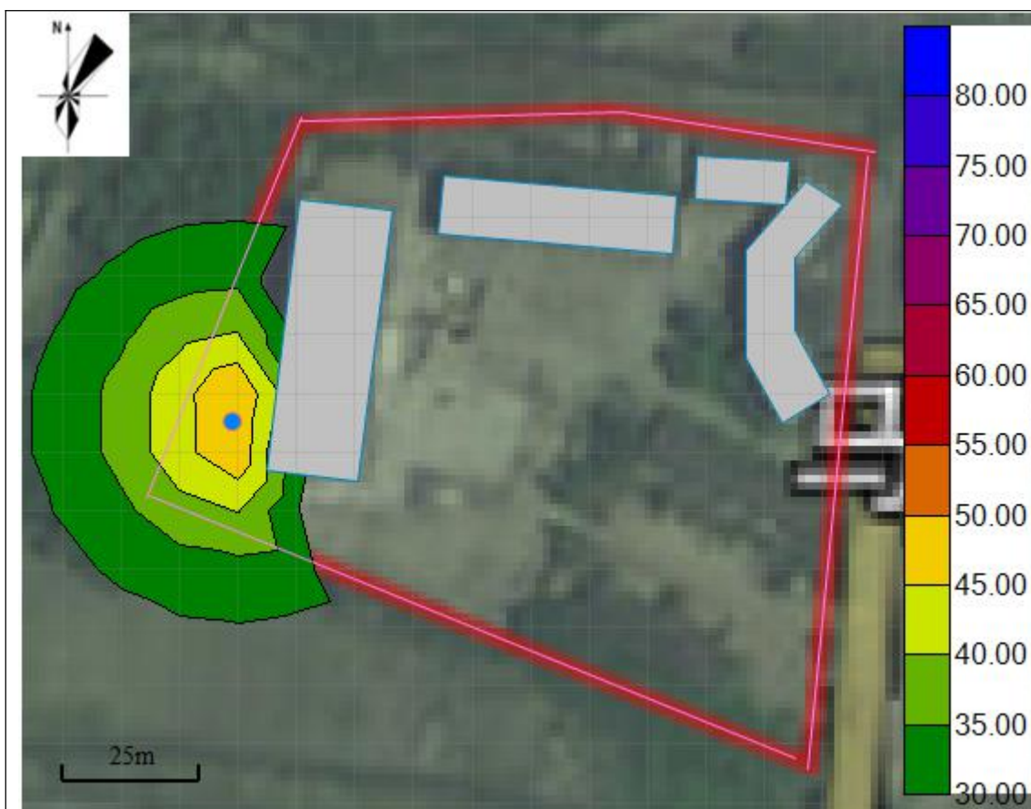
图 7-2 项目噪声预测等声级线图 单位：dB (A)
